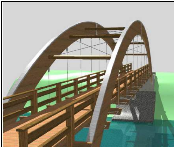
Viste tridimensionali della passerella in legno lamellare in progetto – Giavenale (VI)
